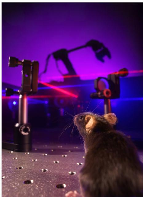
Une nouvelle interface cerveau-machine optique ouvrant la voie à une communication bidirectionnelle avec le cerveau. Le laser rouge permet d'imager l'activité neuronale de la souris et ainsi le contrôle du bras robotique. Le laser bleu va ensuite livrer une microstimulation optique au cerveau, retransmettant la position du bras.
