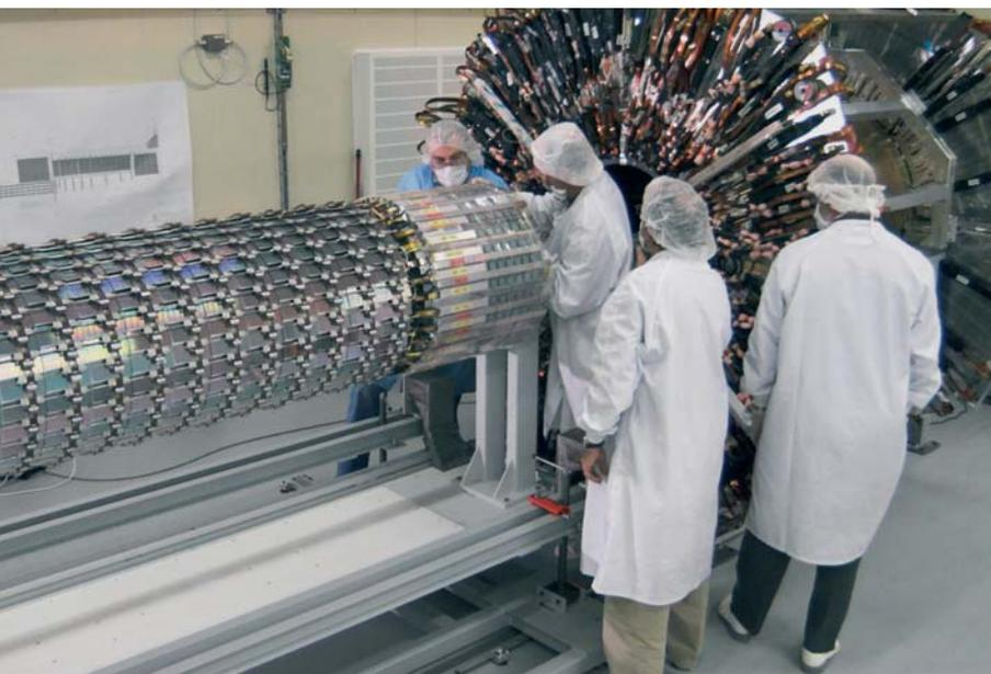
Détecteur de particules du projet ATLAS au grand collisionneur de protons LHC du CERN. Ce détecteur est basé sur des senseurs semiconducteurs, qui sont la spécialité du Département de physique nucléaire et corpusculaire. Ici, les chercheurs font une dernière inspection d'une partie de l'instrument avant de l'insérer dans le coeur du détecteur.
