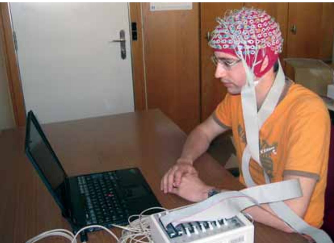
Julien Kronegg effectue des tâches mentales que l'ordinateur est censé reconnaître grâce à un dispositif d'électrodes placées sur le crâne et à un logiciel de traitement des signaux. Les meilleurs résultats affichent 92% de réussite.
