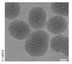
Cette micrographie électronique montre la nature poreuse des nanoparticules de silice. Ces pores sont suffisamment grands pour permettre l'entrée d'un grand nombre de molécules NSA. Elles y sont protégées jusqu'à ce qu'elles soient absorbées par les cellules immunitaires. À ce stade, les NSA sont libérées et peuvent arrêter les processus inflammatoires.
