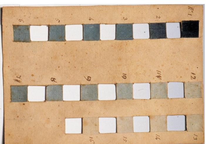
Le cyanomètre imaginé par Horace-Benedict de Saussure pour mesurer le bleu du ciel, avec 16 tons de bleus, numérotés du presque noir au presque blanc. Des chiffres ont été raturés, ce qui incite à penser que l'instrument était encore un prototype. Cet objet a donc beaucoup de valeur car les instruments d'essai sont rarement conservés.
