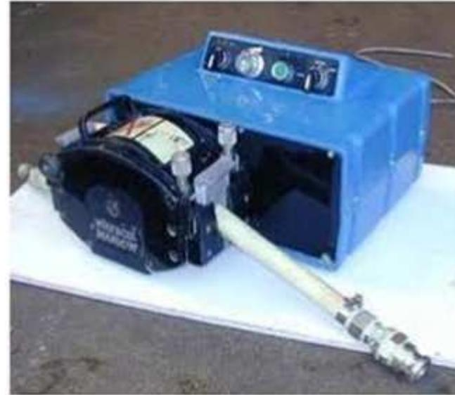
**Explication:** Les pompes péristaltiques sont des pompes étanches, dont le seul élément en contact avec le fluide est le tube flexible. Les risques de fuite sont ainsi limités, et le volume de liquide déplacé est proportionnel à la vitesse de rotation de la pompe. C'est pourquoi ce type de pompe est particulièrement adapté au dosage, grâce à sa souplesse d'utilisation et sa grande précision.
