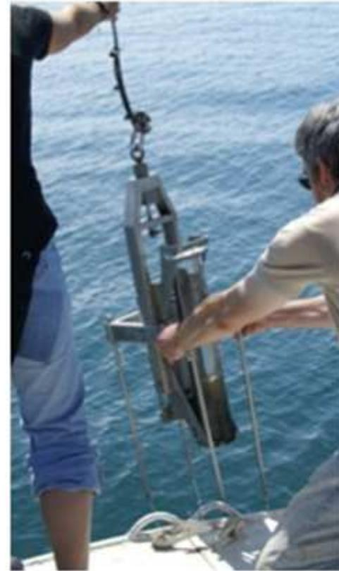
**Explication:** Le carottier gravitaire Mortimer permet d'obtenir des carottes de maximum 50 cm de longueur et de 7.0 cm de diamètre intérieur, dans un tube transparent avec système de fermeture qui abime très peu l'interface eau – sédiment.
