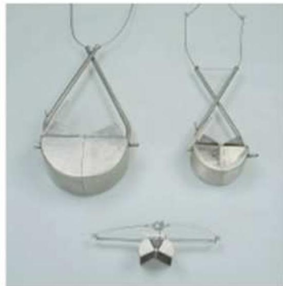
**Explication:** Les bennes "Van Veen", en acier inoxydable, sont utilisées pour la prise facile d'échantillons remaniés au fond de lacs, rivières, etc.
