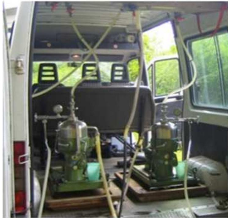
**Explication:** Centrifugeuse à flux continu, permettant de récolté les matières en suspensions dans les rivières et les lacs. Débit 6 L/min à 12000 t/min
