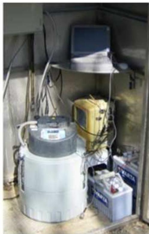
**Explication:** Cet instrument est piloté par débitmètre, par une montre, ou autre système ce qui permet de prélever automatiquement un échantillon d'eau chaque fois qu'un volume d'eau déterminé a passé le site de mesure.
