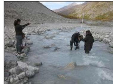
**Figure 13:** Mesure classique du débit de la rivière pro-glaciaire: largeur du cours d'eau, profondeur et vitesse d'écoulement.
