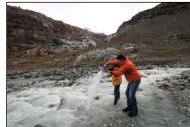
**Figure 12:** Mesure du débit de la rivière pro-glaciaire par salage.
