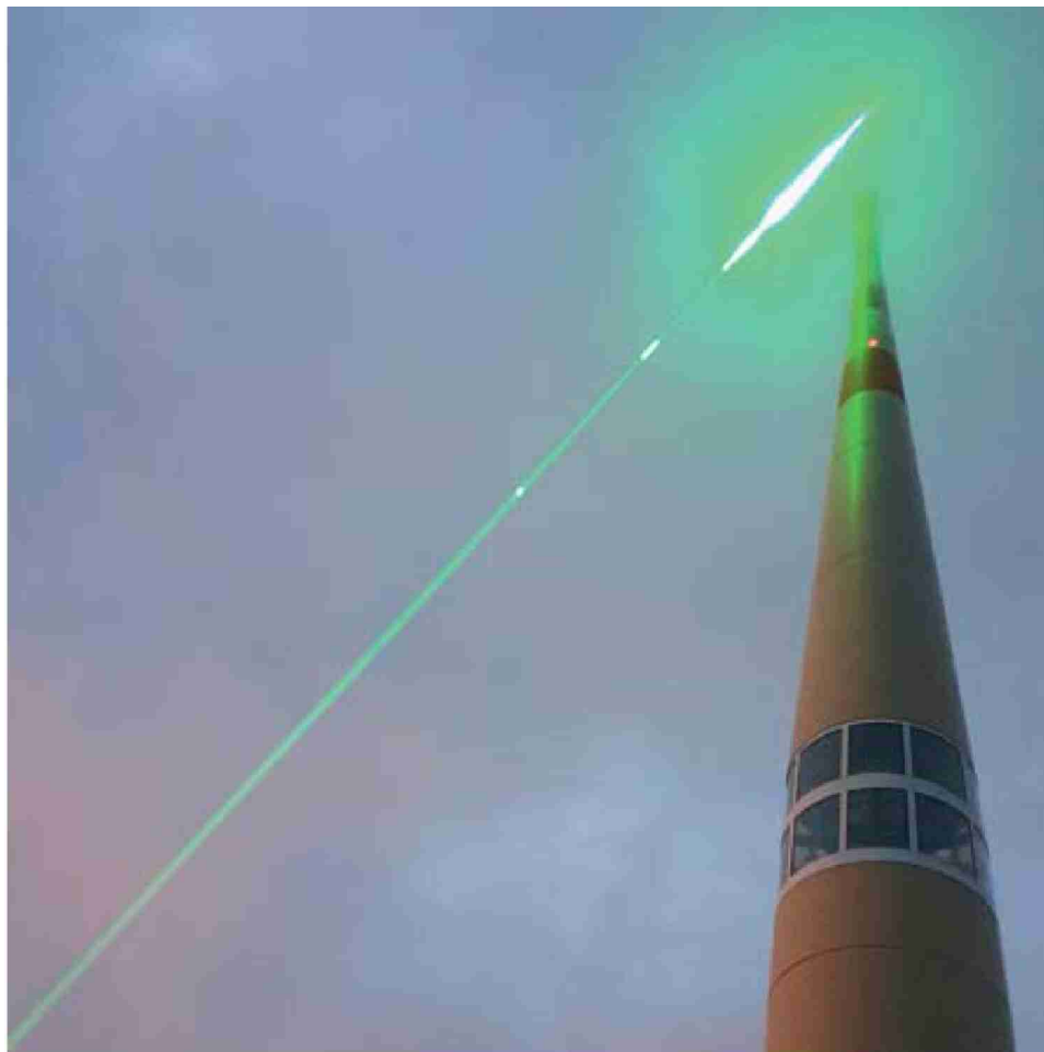
Le rayon laser frôle la tour de 124 mètres du Säntis, et détourne la foudre. SP - JEAN-PIERRE WOLF
