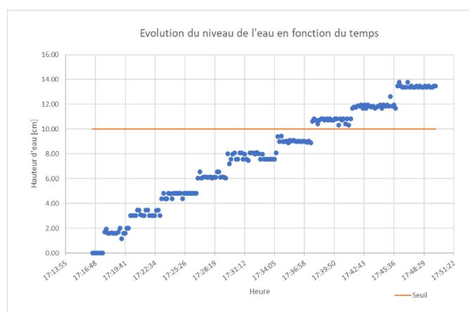
Malgré la variabilité de certaines mesures notamment vers 2 cm, 3 cm et 8 cm, le graphique montre bien l'efficacité du dispositif après chaque ajout d'eau supplémentaire. Les mesures prises par le capteur sont comprises à +/- 0.3 cm des mesures effectuées avec la règle graduée standards. Enfin la LED rouge s'allumait bien lorsque la hauteur dépassée le seuil de 10 cm que nous avions programmé.
