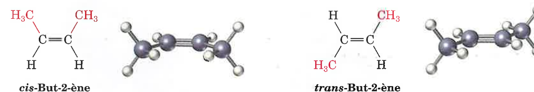
FIGURE 3.2 Isomères cis et trans du but-2-ène. L'isomère cis a les deux groupements méthyle du même côté de la double liaison, tandis que l'isomère trans a les deux groupements méthyle de part et d'autre de la double liaison.
