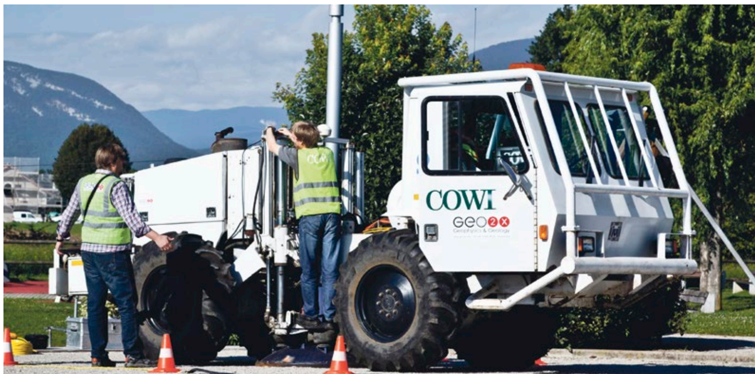
Camion vibreur employé pour sonder le sous-sol dans la région d'Avusy, dans le cadre du programme Géothermie 2020. Photo: SIG
