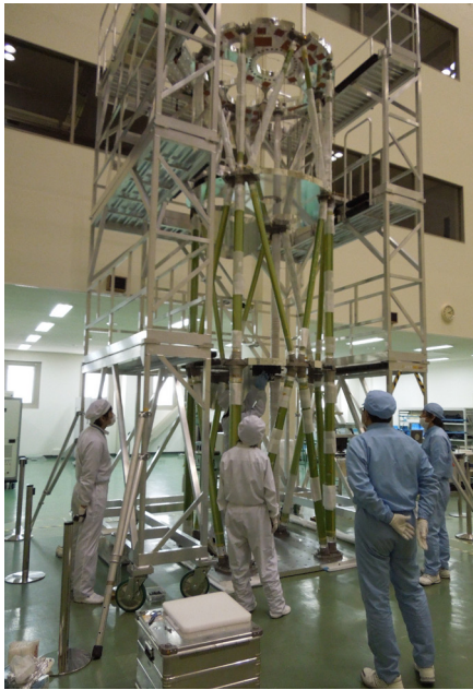
Roue à filtres en cours d'intégration en vue de tests mécaniques sur la structure du satellite ASTRO-H. La structure mesure 6 m. de hauteur; ASTRO-H se déploiera dans l'espace pour atteindre 12 m. de longueur.
