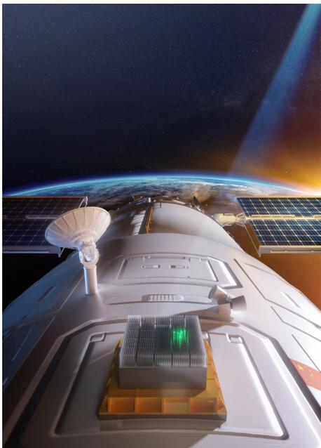
L'expérience POLAR sur le laboratoire spatial chinois Tiangong-2, lancé le 15 septembre 2016. La lumière verte incandescente imite la lumière scintillante lorsqu'un photon gamma frappe l'une des 1600 barres de scintillation spécialement conçues. Cette vue d'artiste est basée sur une photo prise par une caméra située à plusieurs mètres derrière POLAR.
