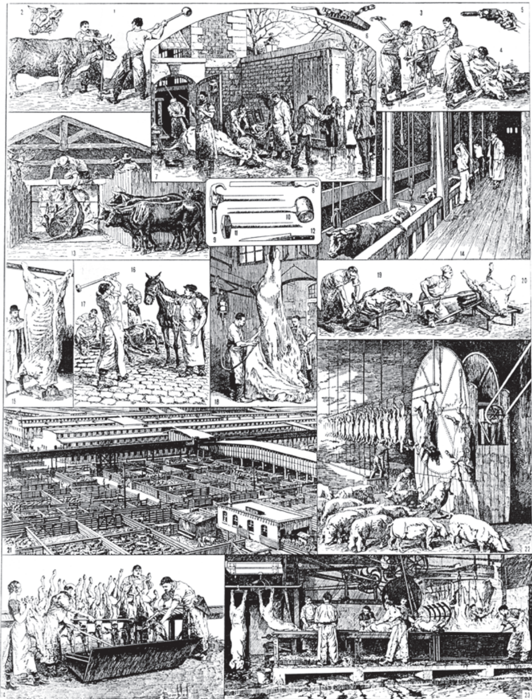
ABATTOIR : 1. Abatage d'un boeuf au maillet avec le manche Brunen; 2. Le manche Brunen en place; 3. Abatage au merlin anglais; 4. Passage du jone; 5. Flatolet pneumatique; 6. Gaine et couteau (botique); 7. Echaudoir lavé et malades venant boire du sang frais; 8. Couteau du sacrificeur juif; 9. Merlin anglais; 10. Maillet; 11. Merlin; 12. Couteau de saigneur; 13. Abatage dans un « saladero » du Paraguay; 14. Abatage des boeufs à Chicago; 15. Visite vétérinaire; 16, 17. Abatage et saignée d'un cheval; 18. Dépeçage électrique; 19, 20. Enorgement et soufflage d'un veau; 21. Parc à bestiaux à Chicago; 22. Abatage et engorgement des porcs à Chicago; 23. Echaudoir et table d'épluage pour les porcs; 24. Egrégement des moutons.
