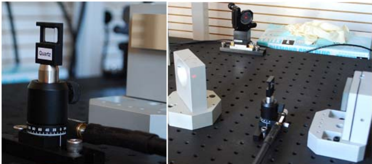
Figure 13. Une lame de quartz sur la monture tournante dans un des bras de l'interféromètre
