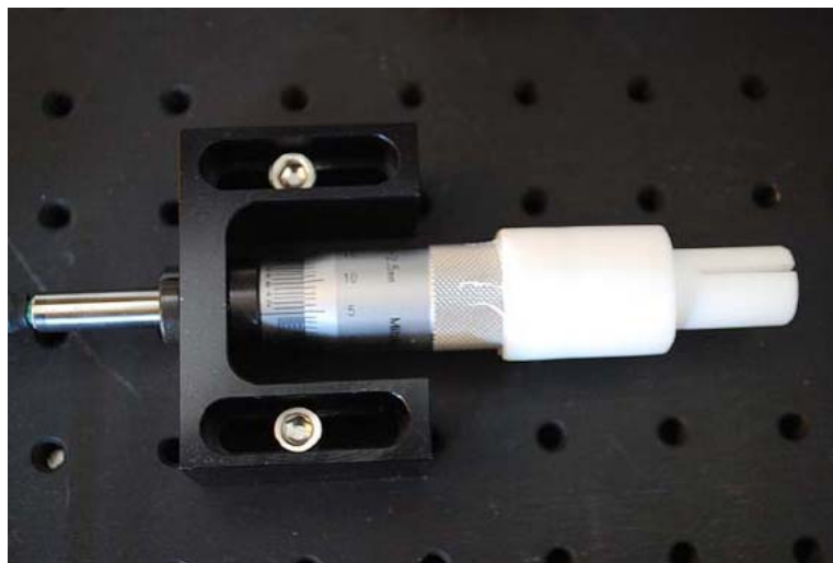
Figure 8 : le micromètre différentiel, course de 2,5mm maxi
