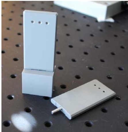
Figure 5 : Les tours d'alignement avec leur support peuvent être utilisées directement sur la table optique
