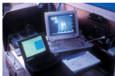
Fig. 5. Système de positionnement par satellite à bord du bateau d'accompagnement du F.A.-Forel.
