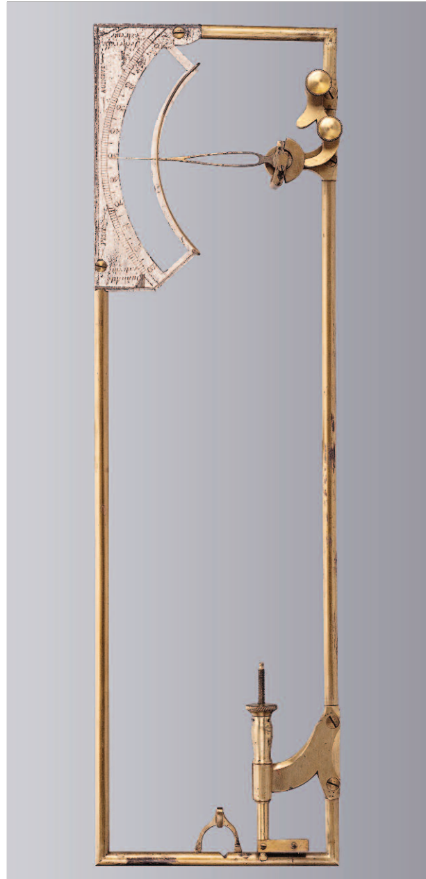
Fig. 3. Hygromètre à cheveu type Saussure construit par Paul ayant peut-être appartenu à Senebier (MHS-355). © MHS, Photo Philippe Wagneur.
