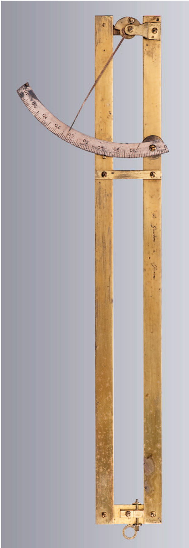
Fig. 4. Hygromètre à cheveu type Saussure de voyage amélioré par Gourdon ayant peut-être appartenu à Senebier (MHS-4). © MHS, Photo Philippe Wagneur.
