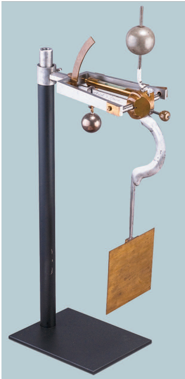
Fig. 1. A: Anémomètre de type Saussure ayant appartenu à Senebier (MHS-13). © MHS, Photo Philippe Wagneur.
