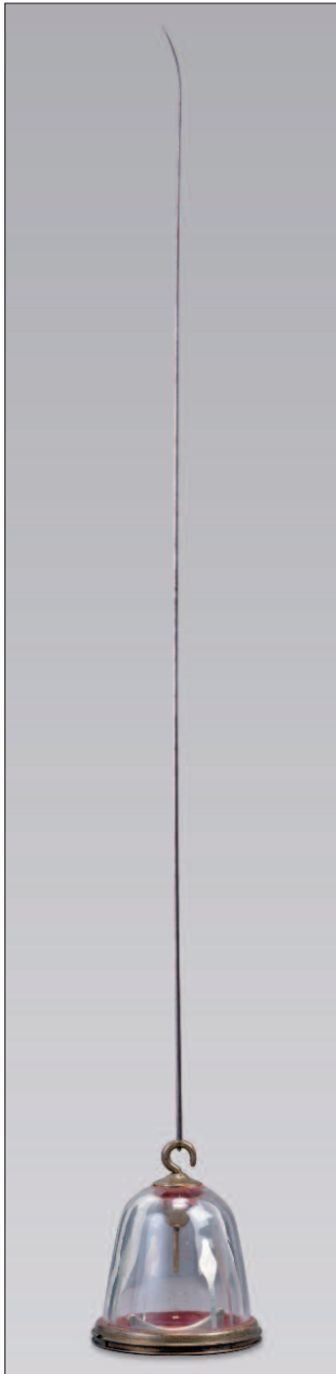
Fig. 2. Electromètre de type Saussure ayant peut-être appartenu à Senebier (MHS-544). © MHS, Photo Philippe Wagneur.
